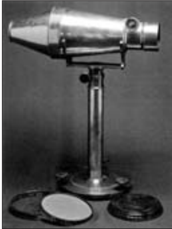
Orthoskop-krajinársky objektív vyrobený Voigtländerom podľa výpočtov J. M. Petzvala.
