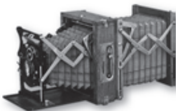
Sklopný fotografický prístroj s dvojitým výťahom v Múzeu J. M. Petzvala v Spišskej Belej.
