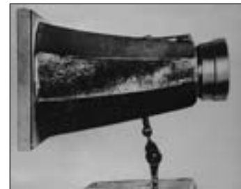
Prvý fotografický objektív J. M. Petzvala, odskúšaný za pomoci knihovníka polytechni- ky A. Martina v roku 1840.
