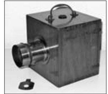
Jeden z prvých prototypov fotografického aparátu s Petzvalovým objektívom.
