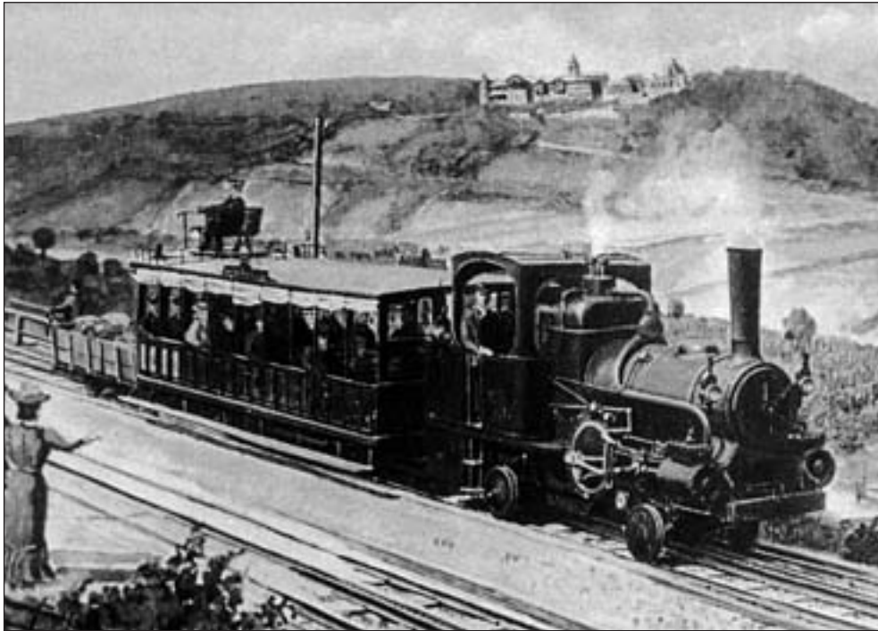
Zubačka na viedenský Kahlenberg, otvorená 7. marca 1874 z príležitosti svetovej výstavy vo Viedni. Z blízkeho Nassdorfu 5km vzdialenosť s výškovým rozdielom 175m prekonala za 27 minút rýchlosťou 12km/h.
