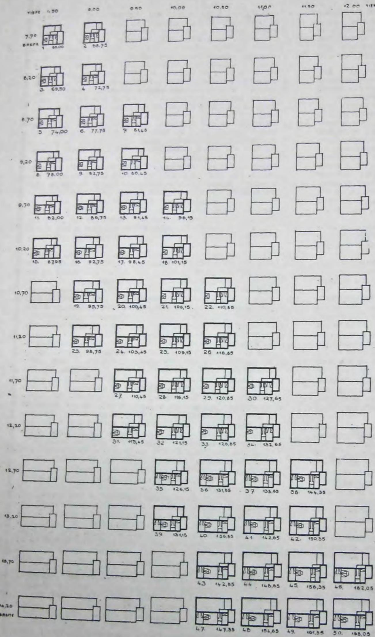
Среди наших архитекторов и строителей чрезвычайно распространено мнение, что глубину жилого корпуса нужно делать как можно большей. Между тем вопрос глубины корпуса жилого здания есть функция площади квартиры и конструктивной схемы, принятой для данного типа.
