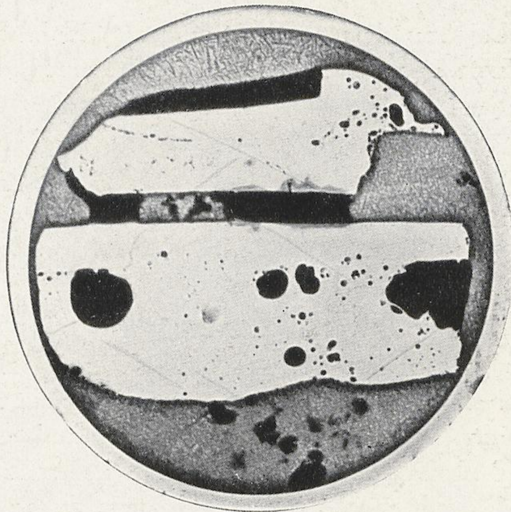
abb. 16 metallstrukturen 2 kupferstücke zusammengesweißt ( 2\frac{1}{2} mal vergrößert)
