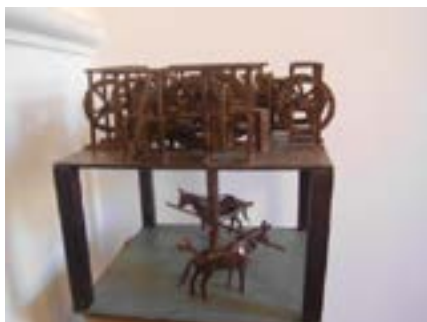
Ilustracion 36 Sistema de manejo, engranaje a linterna y de angulo utilizado en los Molinos e la Casa de Moneda circular de Potosí. José A. Fuertes López: Molinos de Sangre, Potosí 1998
