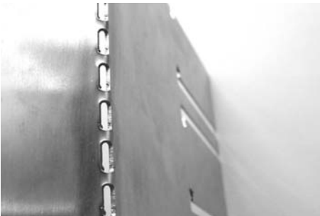
Perforiertes Biegedetail, CAAD-Bookletständer Oliver Fritz, CAAD ETH Zürich
