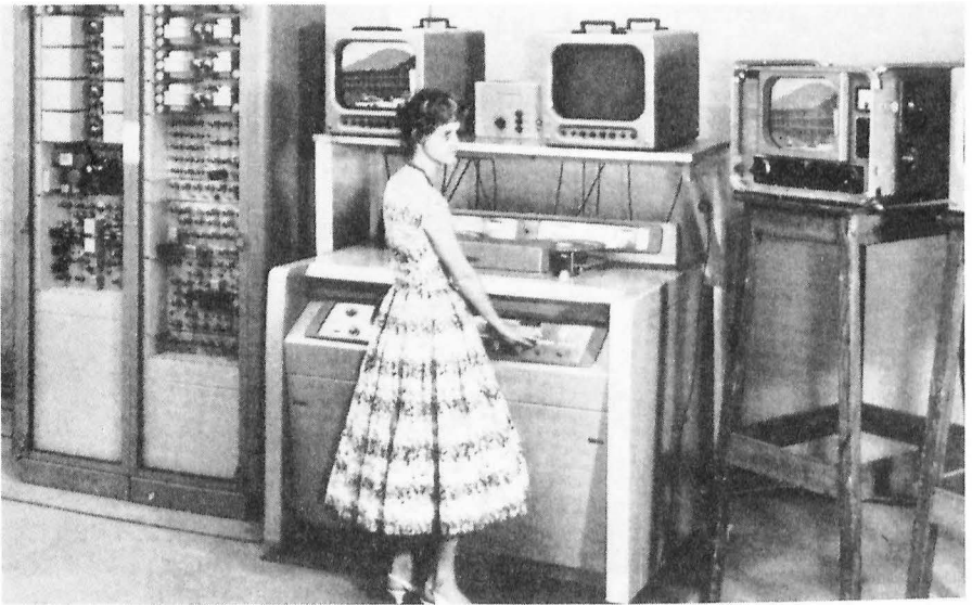
Der erste - von Siemens & Halske für die europäische Fernsehnorm modifizierte - Ampex-Recorder des SWF im Funkhaus Baden-Baden (Quelle: SWF Technische Blätter, Heft 3/1958, S. 5)
