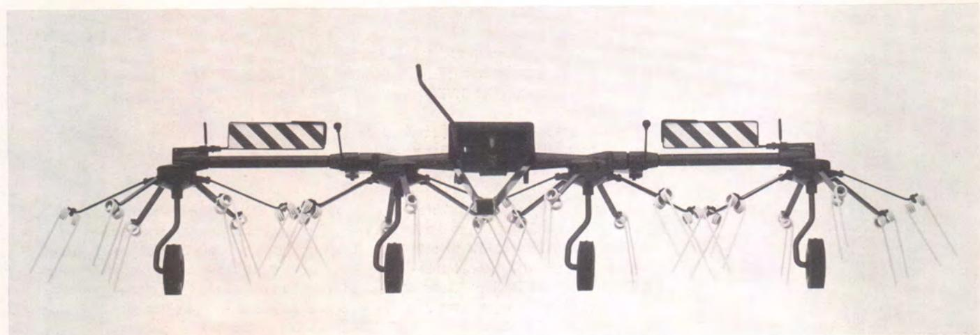
*Maschine in Transportstellung (Außenarme nach hinten geklappt)./Machine in position for moving on roads (exterior arms bent backwards).*
