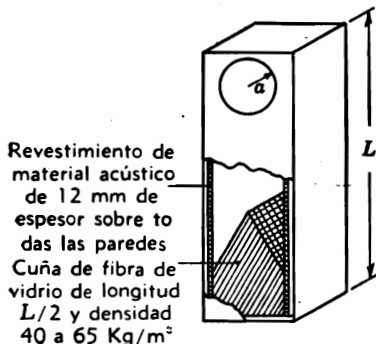
Fig. 8.9. Tipo especial de gabinete para reducir al mínimo el desplazamiento de la frecuencia de resonancia de un altavoz montado en un sonodector de caja cerrada.
