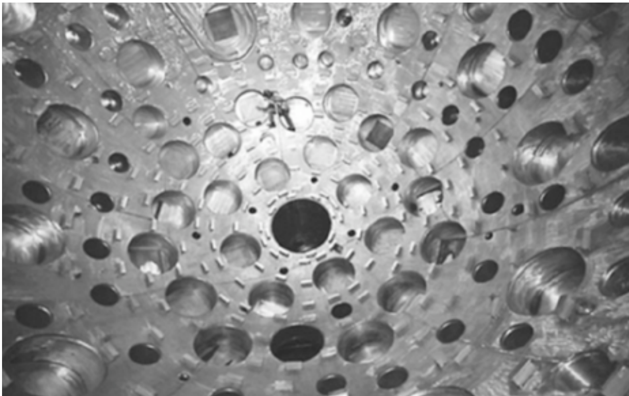
Le National Ignition Facility (NIF) est une unité de confinement inertiel par laser (pour amorcer une réaction de fusion nucléaire) en construction au Laboratoire National Lawrence Livermore, à Livermore, Californie. Le NIF est le plus grand laser à confinement inertiel jamais construit. Ici, la chambre d'interaction de 10 mètres de diamètre, percée d'un ensemble d'ouvertures par où pénétreront les 192 faisceaux et où seront implantés des diagnostics de contrôle et d'observation. Le résultat espéré est "l'ignition", la réalisation de réactions de fusion nucléaire auto-entretenues.
