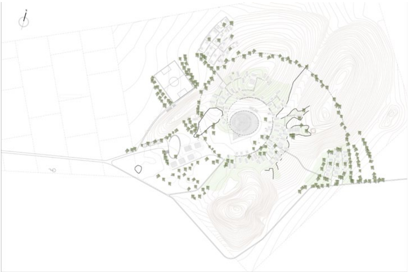
▲ Plan of the opera village with the festival hall as the spiral's nucleus, surrounded by residential units; school with film and music classes to the western side Plan des Operndorfs mit dem Festspielhaus in der Mitte der Spirale, umgeben von Wohnmodulen, westlich davon die Schule mit Film- und Musikklasse
