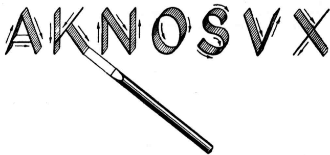
Рис. 25. Схема, иллюстрирующая происхождение характерных очертаний букв латинского шрифта
