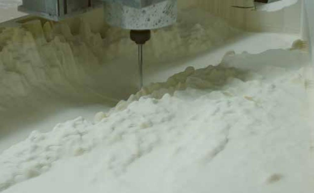
**Robotička CNC kompjuterska izrada jednog topografskog modela.**
